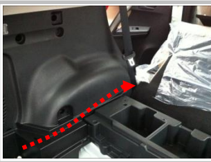
3.14 布正极线：首先把连接正极的延伸线从尾箱内侧穿到后门迎宾踏板处；(虚线)
