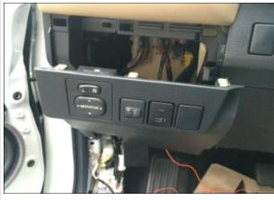
3.17 接正极：方法 1 在驾驶室左边装饰件内找到我们要接的正极电源；(箭头)
