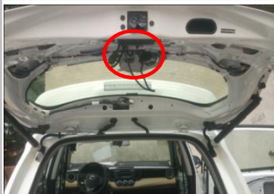
3.5 拆下尾门上盖板, ECU 安装如图示位置 注意如图拍摄角度
