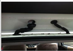
3.2 布线: 把驱动盒线、正极线、穿过波纹管
