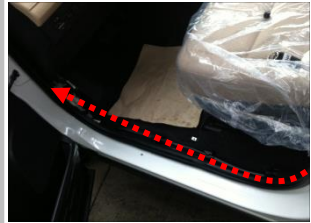
3.16 布正极线：掀开前门迎宾踏板胶条，正极线由此处延伸到驾驶室方向盘左侧；(虚线)
