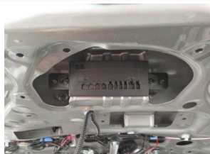
3.6 ECU 上置, 注意如图拍摄角度
