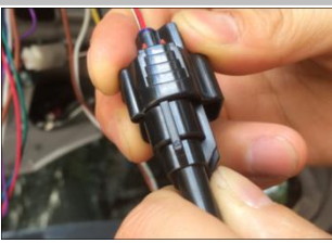
3.12 接尾门信号线: 用我司配的信号线转接插头对插, 注意图片拍摄角度
