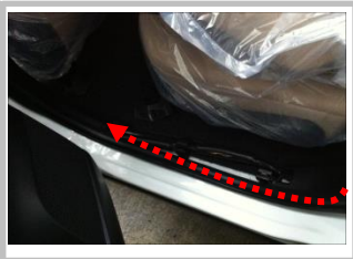
3.15 布正极线：掀开后门迎宾踏板胶条，正极线由 B 柱内延伸到前门迎宾踏板处；(虚线)
