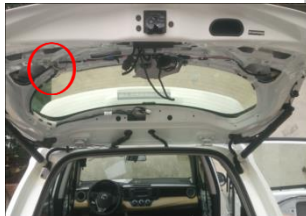
3.8 接负极: 在上尾门左侧附近此位置找到原车螺栓柱大概位置;
