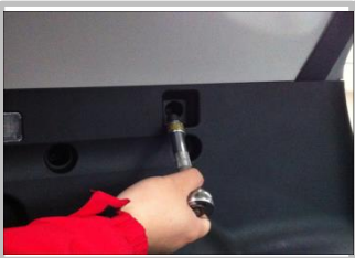
3.13 拆下尾箱内左侧装饰件上的螺钉，并妥善保管
