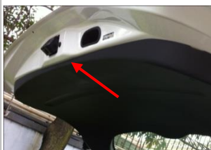
3.10 接尾门信号线: 在尾门锁处找到原车信号线插头
